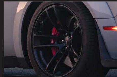
FRENOS BREMBO® DE ALTO RENDIMIENTO CON CALIPERS DE 6 PISTONES EN COLOR ROJO EN EL EJE DELANTERO
